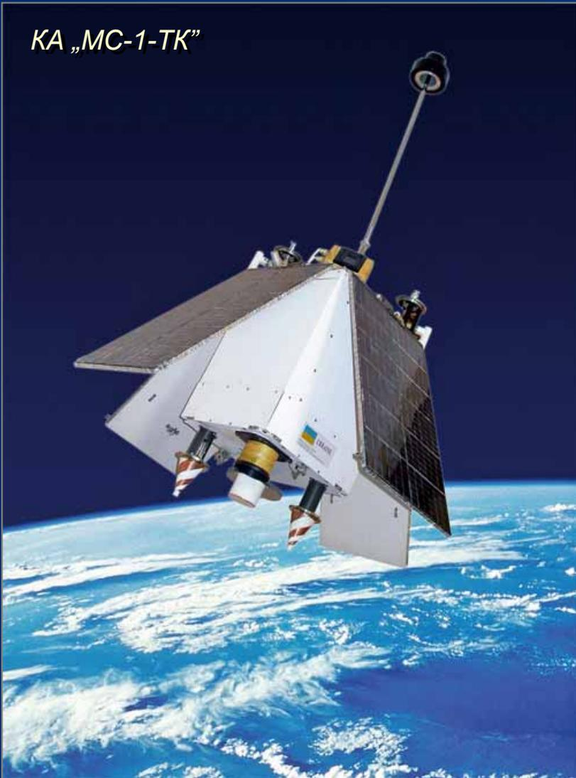
Первый украинский экспериментальный микроспутник “МС-1-ТК” создан для отработки спутниковой платформы МС-1, новых конструктивно-технологических решений, технологии планирования проведения наблюдений в реальном масштабе времени, а также для решения отдельных задач дистанционного зондирования Земли.
