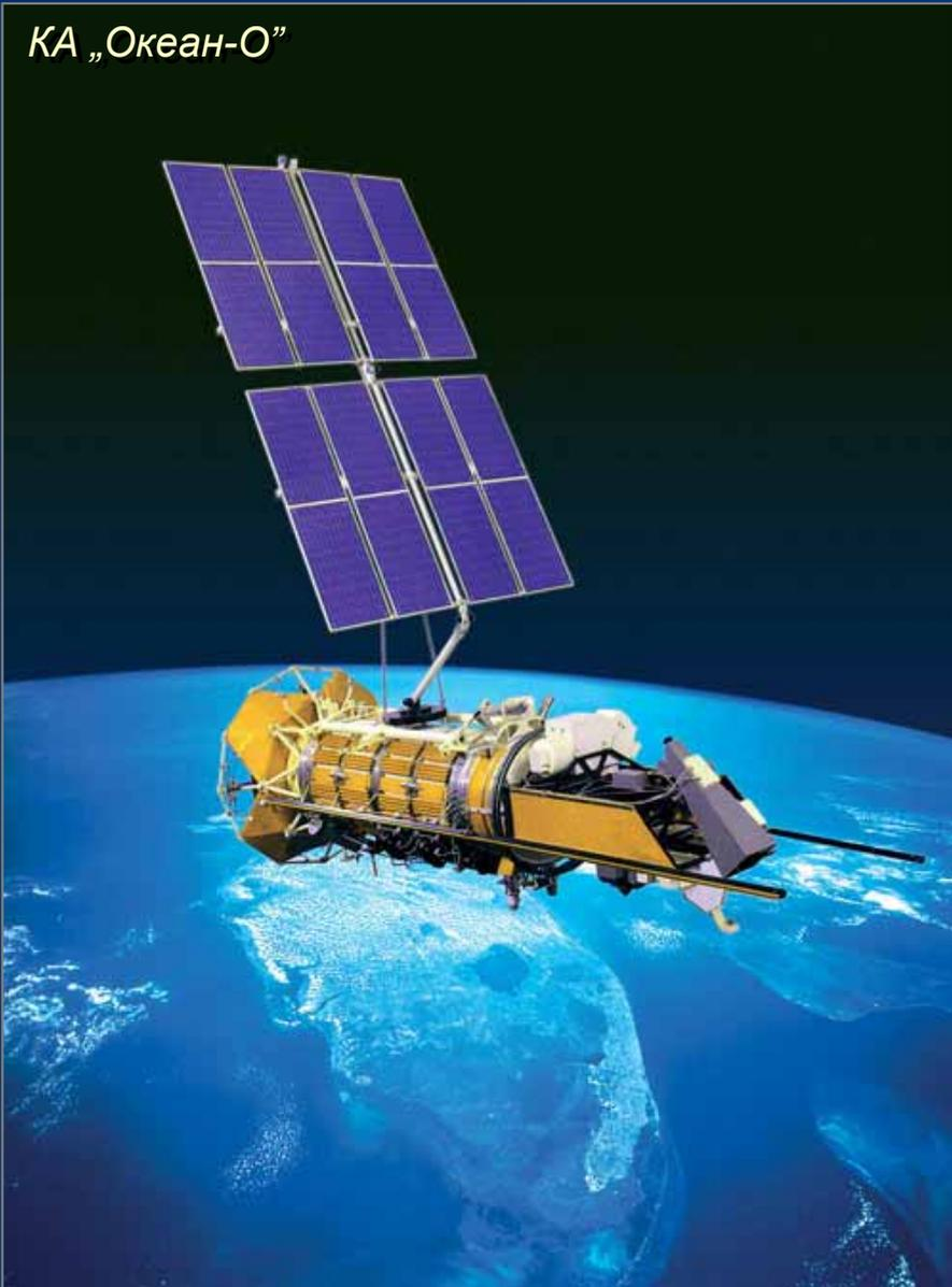
Существенным шагом в развитии системы наблюдения Земли стал запуск в 1999 году вместе с Россией природоресурсного космического аппарата “Океан-О”, на борту которого был установлен комплекс аппаратуры в составе радиолокатора бокового обзора и трех многоспектральных сканирующих приборов разной пространственной разрешающей способности.
