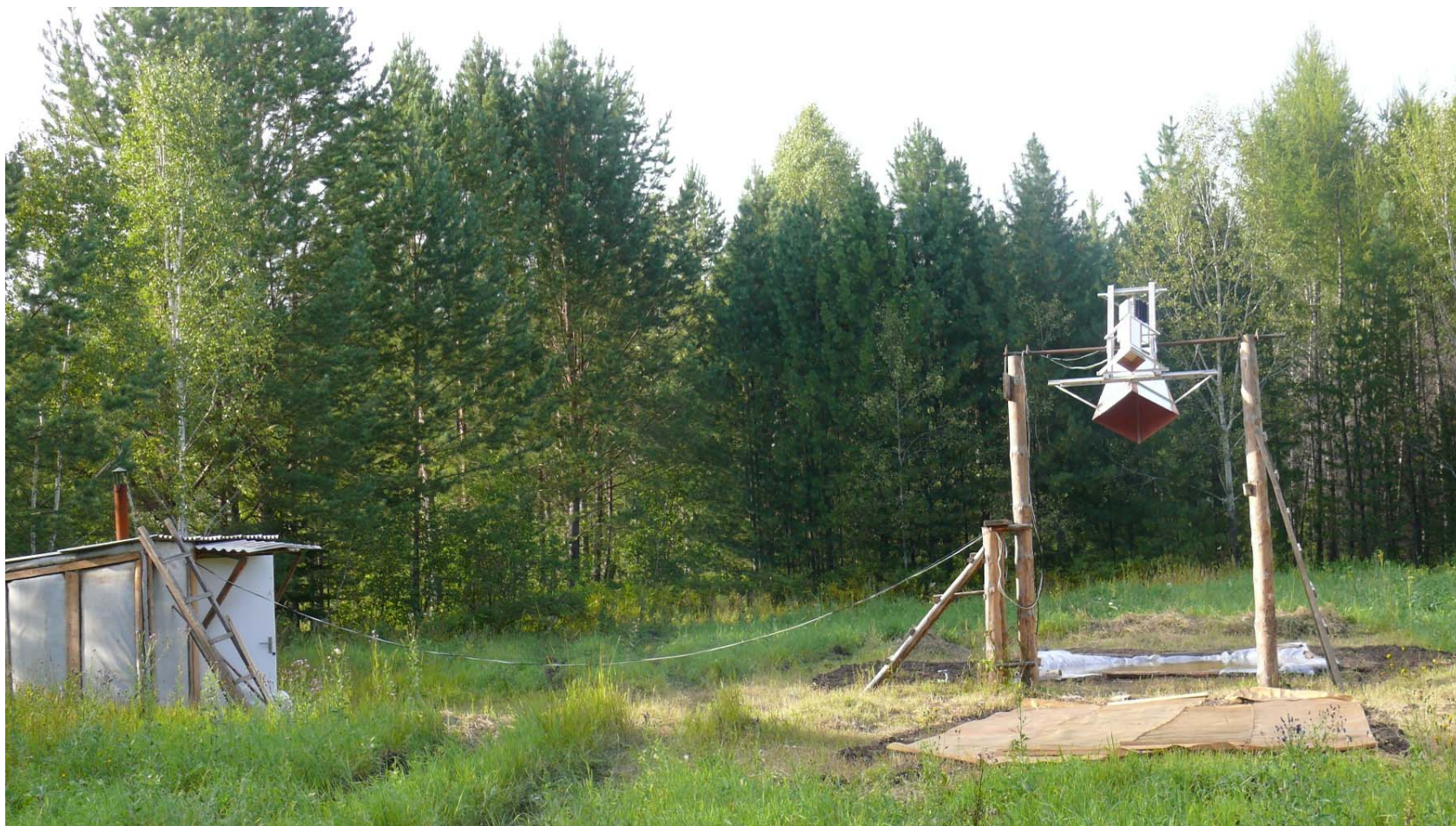
Радиометрический комплекс на длины волн 4.3 и 21 см. (Институт физики им. Л.В. Киренского КНЦ СО РАН)
