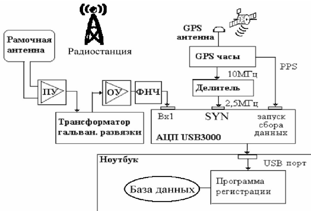
Рис. 3. Блок-схема измерительного комплекса для регистрации сигналов радиостанций
