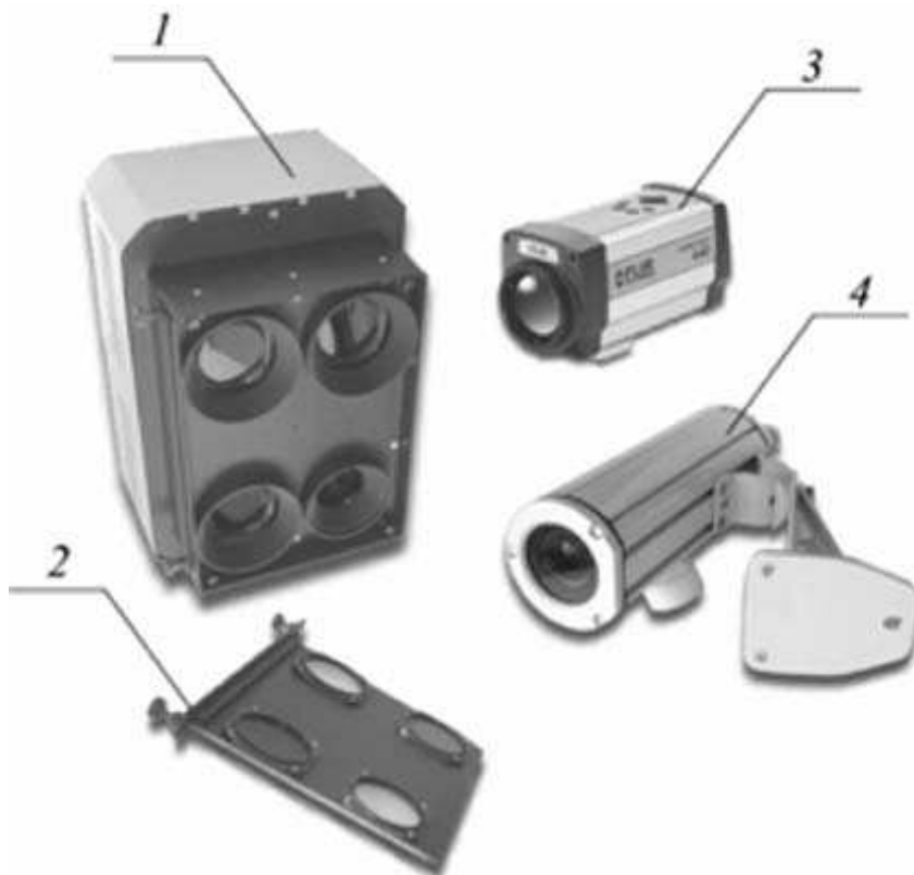
Рис. 1. Внешний вид основных модулей блока оптических датчиков: 1 – модуль спектральной съемки; 2 – сменная кассета светофильтров модуля зональной съемки; 3 – модуль инфракрасной съемки; 4 – модуль трассовой съемки
