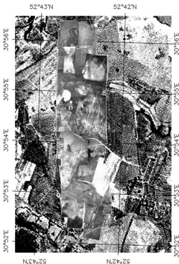
Рис. 3. Пример представления результатов съемочных испытаний в виде картосхемы, построенной наложением мозаики изображений на космический снимок
