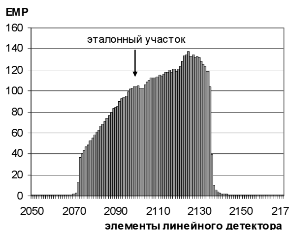
Рис. 6. Профиль яркости ленты (сечение А-А) образцовый лампы
