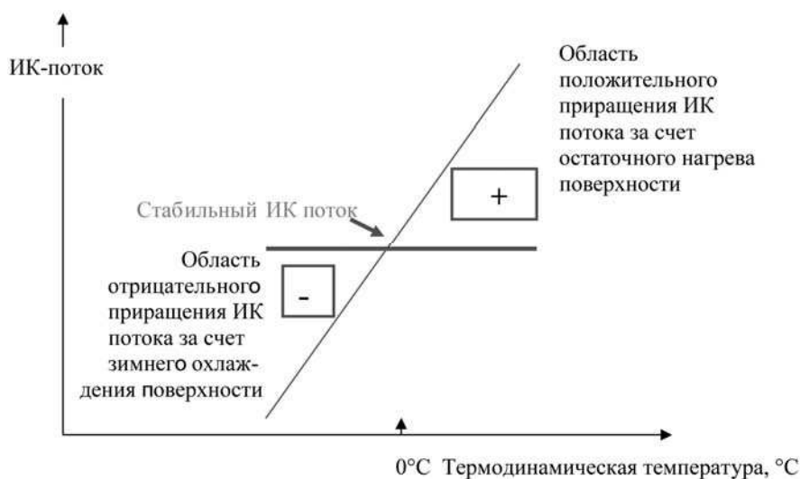
Рис. 4. Схема изменения интенсивности ИК потока под влиянием температуры деятельного (поверхностного) слоя грунта
