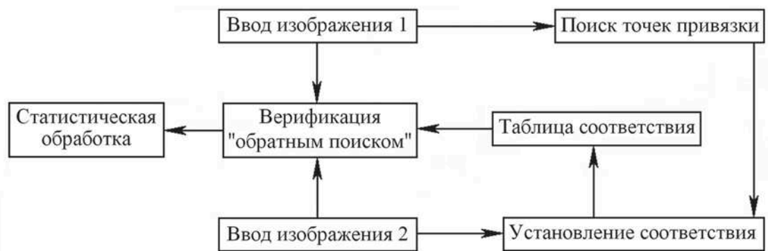
Рис. 2. Структура программного обеспечения, предназначенного для определения статистических характеристик процесса установления соответствия
