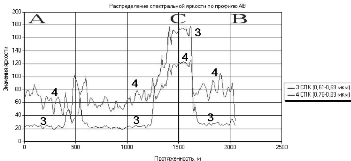
Рис. 2. Изменение яркости по профилю АВ на снимке Рис.1 с КА ALOS в диапазонах 0,61-0,69 мкм и 0,76-0,89 мкм
