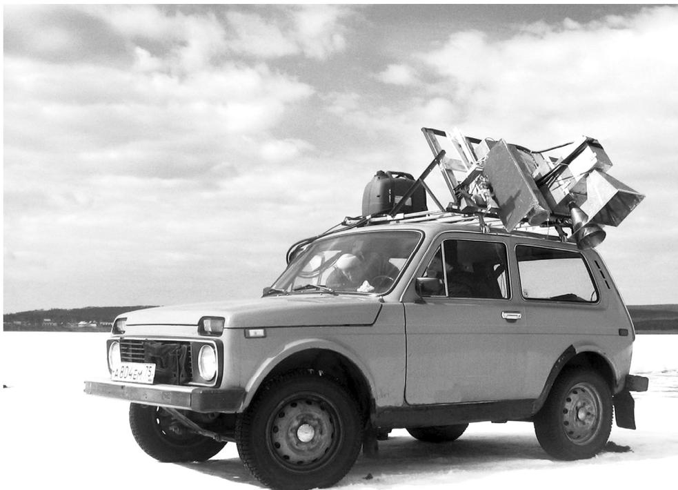
*Рис. 1. Автомобиль-лаборатория с установленным СВЧ-комплексом*
