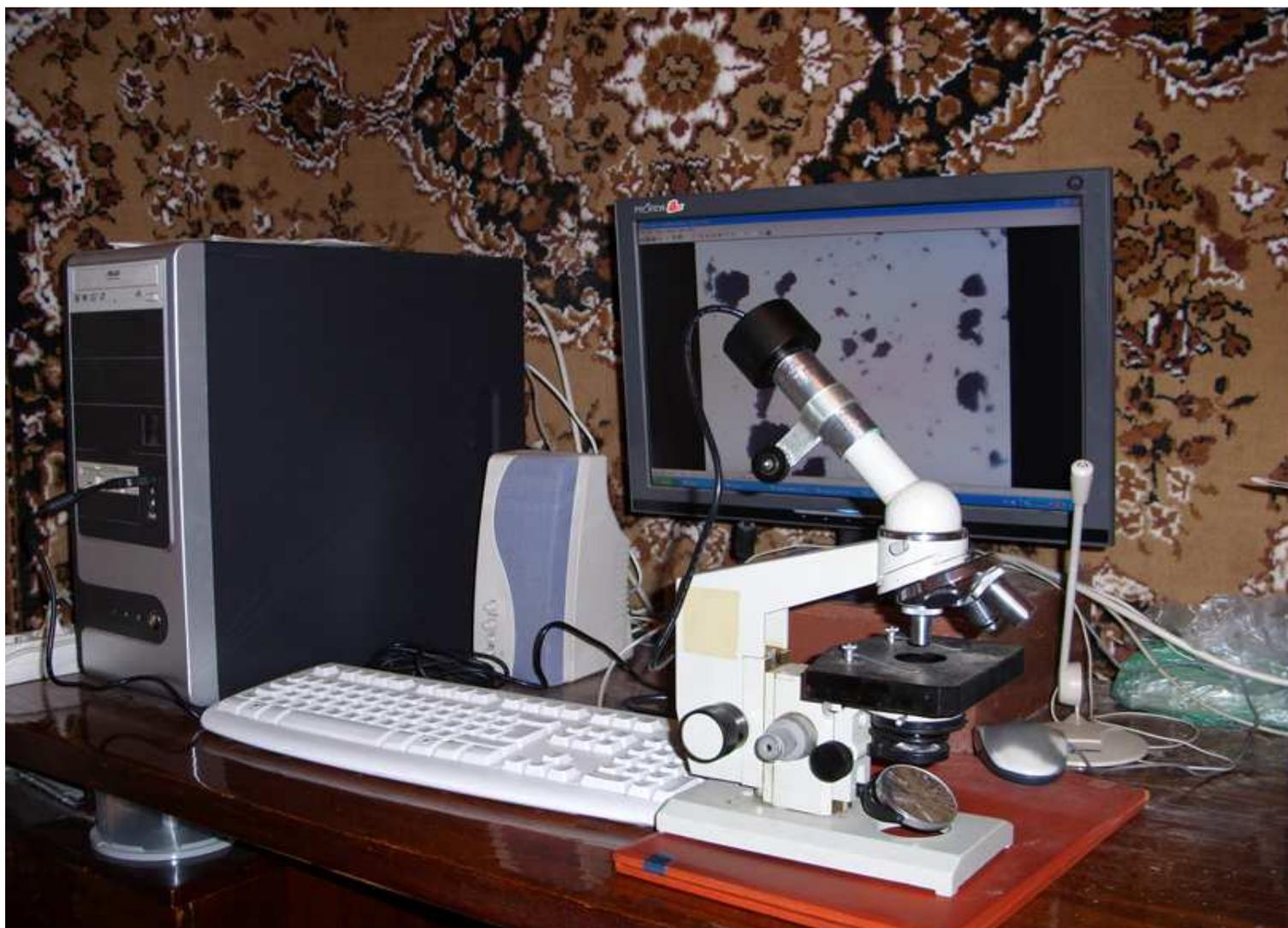
При экспериментальном исследовании гранулометрии определялась зависимость содержания частиц от их размеров для имевшихся образцов.
