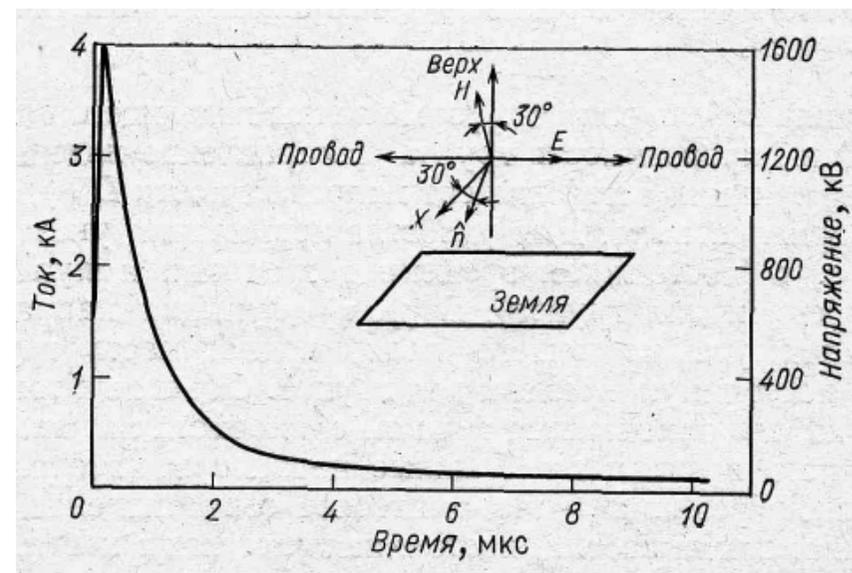
*Импульс, наведенный в проводе при падении волны ЭМИ под углом  $80^\circ$  к вертикали. Электрическое поле вертикально поляризовано. Бесконечно длинный совершенный проводник. Проводимость и диэлектрическая постоянная грунта не зависят от частоты*
