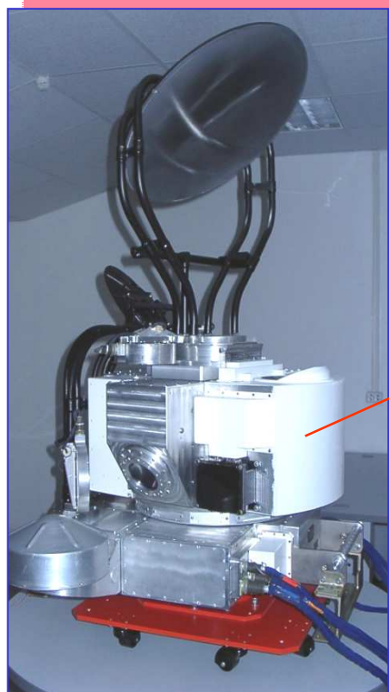
Микроволновый сканер/зондировщик МТВЗА-ОК в составе КА «Сич-1М» (космодром Плесецк, декабрь 2004)
