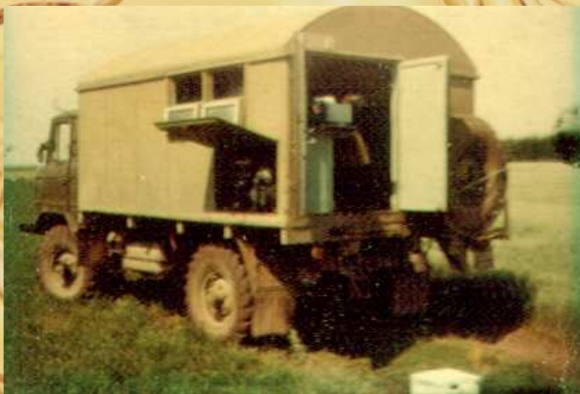
Рис. 1. Регистрация СКЯ растительных покровов спектрофотометром, установленным в полевой оптической лаборатории.
