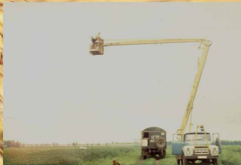
Рис. 2. Регистрация СКЯ растительных покровов (посевов) спектрофотометром, установленным в корзине автовышки.
