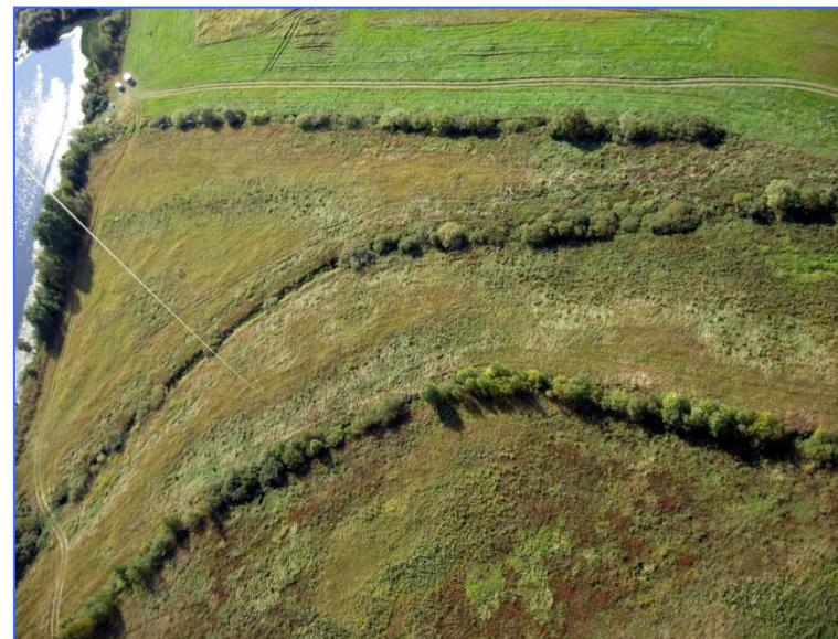
Использование воздушных змеев бескаркасного типа ( $S=2 \text{ м}^2$  и  $7 \text{ м}^2$ ). Высота съемки 50-150 м. Для выравнивания камеры по оси зенит-надир использовали подвес типа «Picavet» (Smith et al., 2009)
