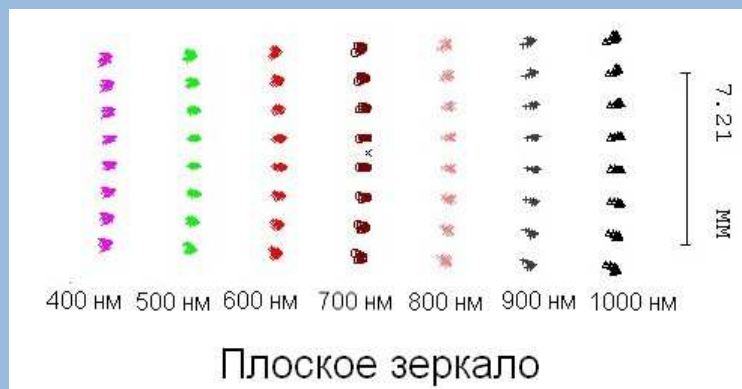
Плоское зеркало Диаграмма пятна в плоскости приемника излучения
