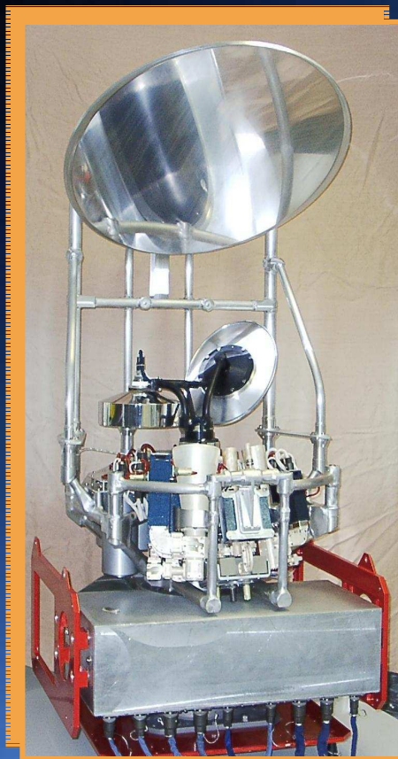
Микроволновый сканер/зондировщик МТВЗА-ГЯ
