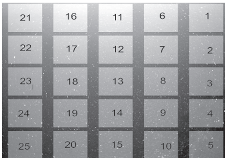
Рис. 4. Схема разбиения кадра ПЗС-камеры на отдельные части для определения направления распространения возмущений
