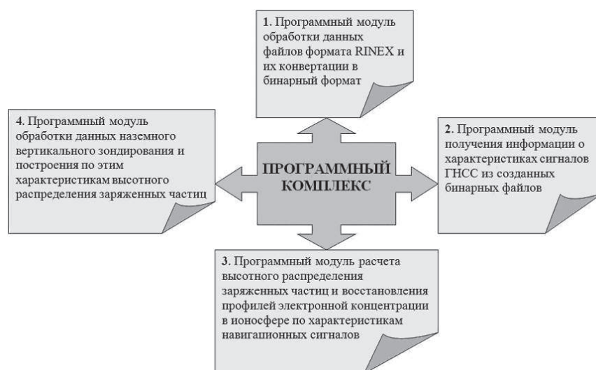
Рис. 1. Программный комплекс определения параметров ионосферы средствами радиозондирования
