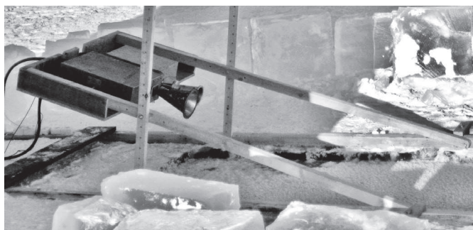
Рис. 3. Фотография установки для измерения мощности теплового излучения льда на проруби на длины волн 0,88 см и 2,3 см
