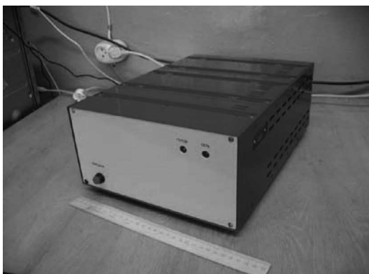
Рис. 3. Аналого-цифровое четырехканальное РПУ БУНИЛ-4 (вид спереди и сзади)
