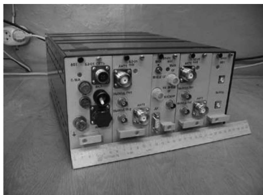
Рис. 3. Аналого-цифровое четырехканальное РПУ БУНИЛ-4 (вид спереди и сзади)
