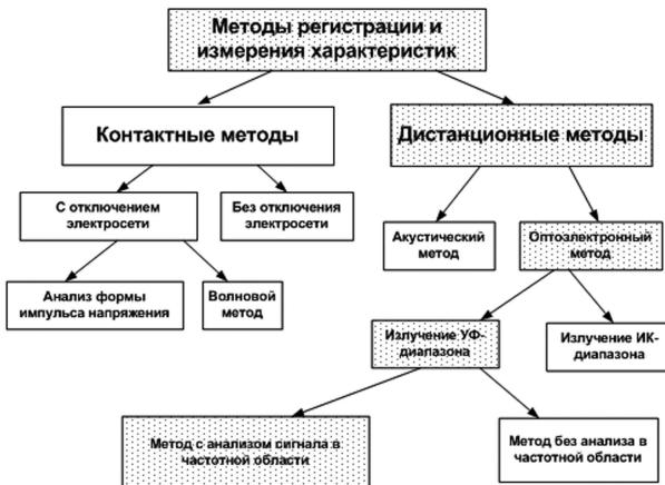
Рис. 2. Классификация методов обнаружения неисправностей на высоковольтных электроустановках
