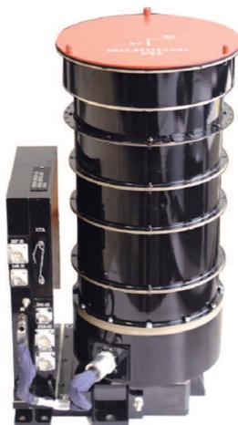
*Рис.4. Прибор звездной ориентации БОКЗ-М*
