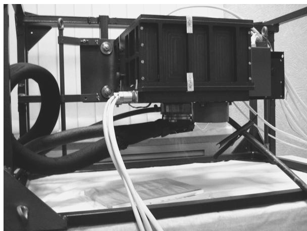
Рис. 1. Оптико-механический блок бортового инфракрасного фурье-спектрометра ИКФС-2 со снятым радиационным холодильником
