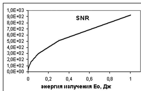
Рис. 4. Соотношение сигнал-шум в зависимости от энергетики лазера
