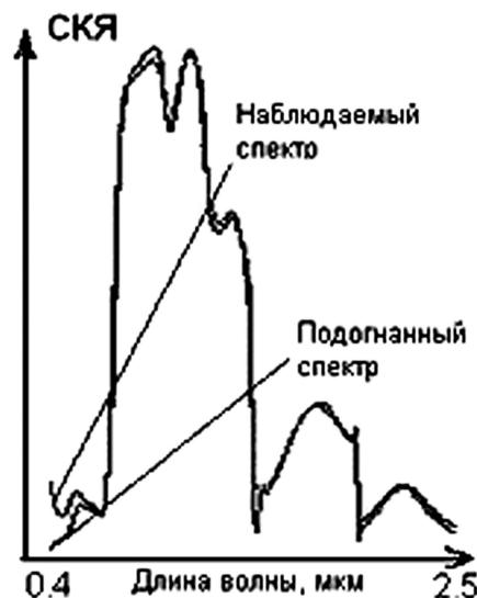
*Рис. 5. Результаты подгонки расчетного спектра (по модели PROSAIL) к спектру измеренному in situ*
