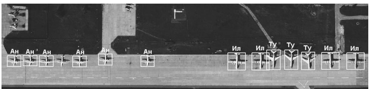
Рис. 8. Результаты автоматического распознавания при использовании признака площади объектов  $S$
