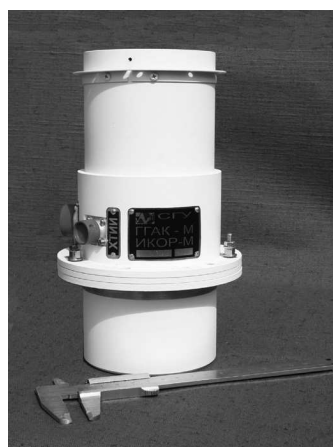
Рис. 1 Радиометр ИКОР-М а) внешний вид; б) схематический разрез
