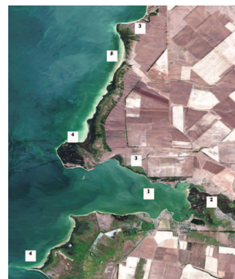
Рис. 5. Конфликтные ситуации левобережья Центрального плеса Цимлянского водохранилища: 1 - «цветение» воды; 2 – зарастание дельты Аксая Есауловского надводными макрофитами, ухудшение условий для нереста рыб; 3 – распашка водоохранной зоны; 4 - размыв берегов ниже отметки 32 м; 5 - образование отмелей
