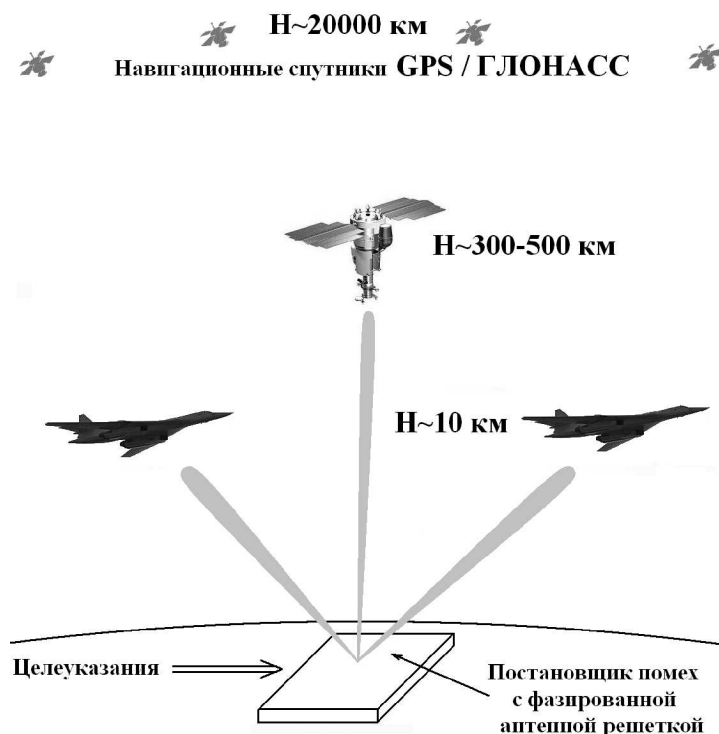
Рис. 1. Прицельное подавление заданных целей с помощью постановщика помех, формирующего необходимое количество лучей
