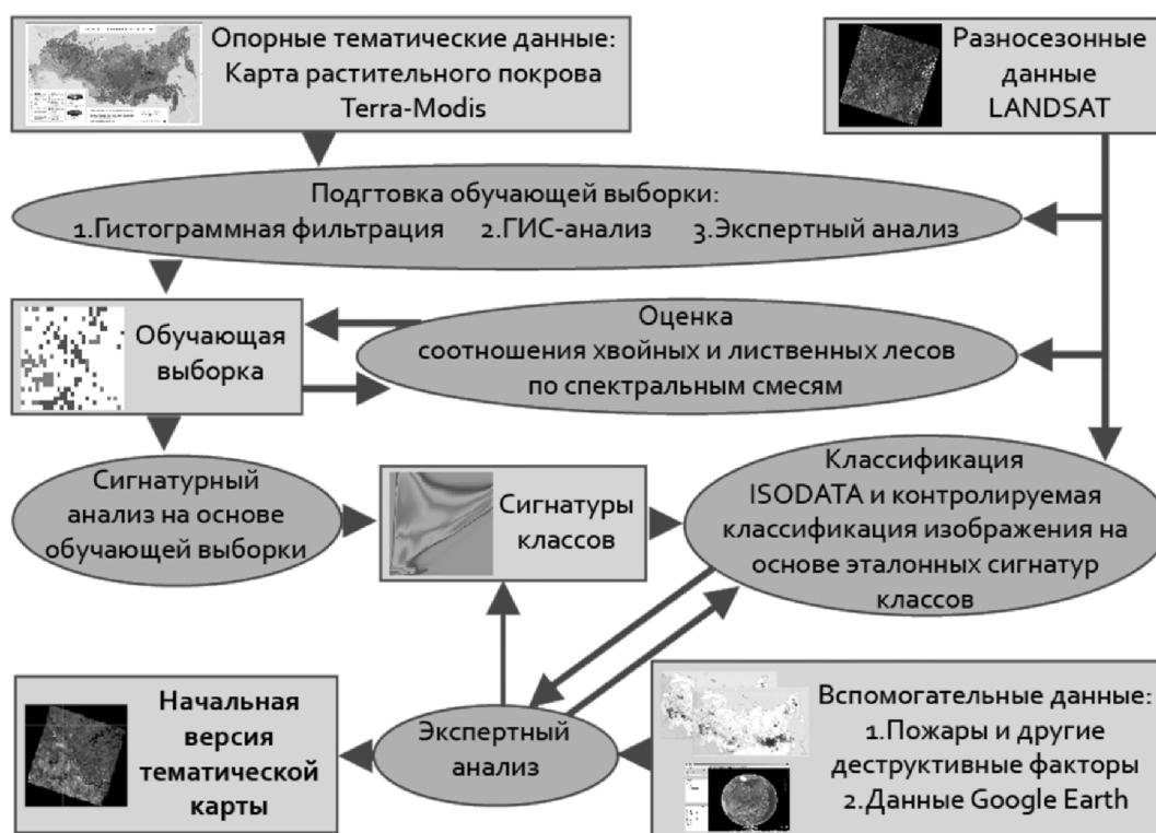
Рис. 4. Блок-схема тематической обработки временных серий спутниковых изображений
