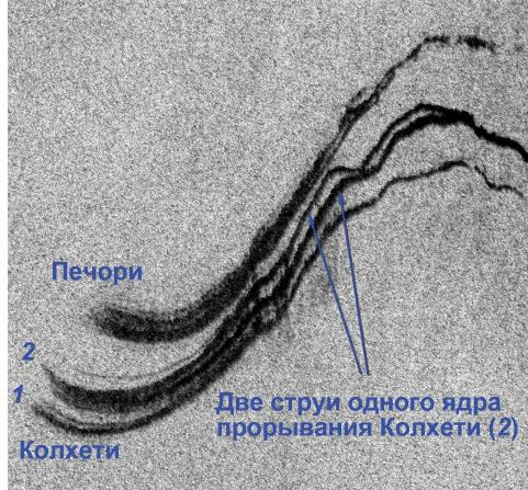
Рис. 3. Нефтепроявления от г. Печори и села Колхети (стрелочками отмечены поверхностные выходы углеводорода 1 и 2 (из 2-х ядер прорывания диапира). Радиолокационное изображение спутника ASAR ИСЗ “ENVISAT” (15.09.2003 7:32 UTC). © ESA
