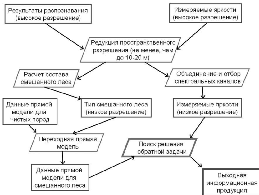
Рис. 1. Схема работы модуля восстановления биопродукционных характеристик древостоя по гиперспектральным изображениям
