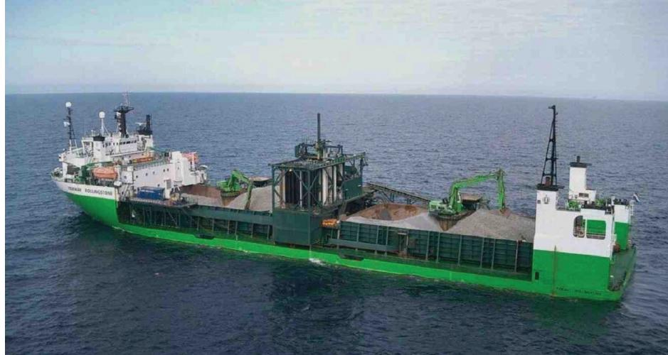
*Рис. 3. Судно Rollingstone, производившее отсыпки гравийно-каменной смеси для достижения устойчивости морского газопровода Nord Stream*
