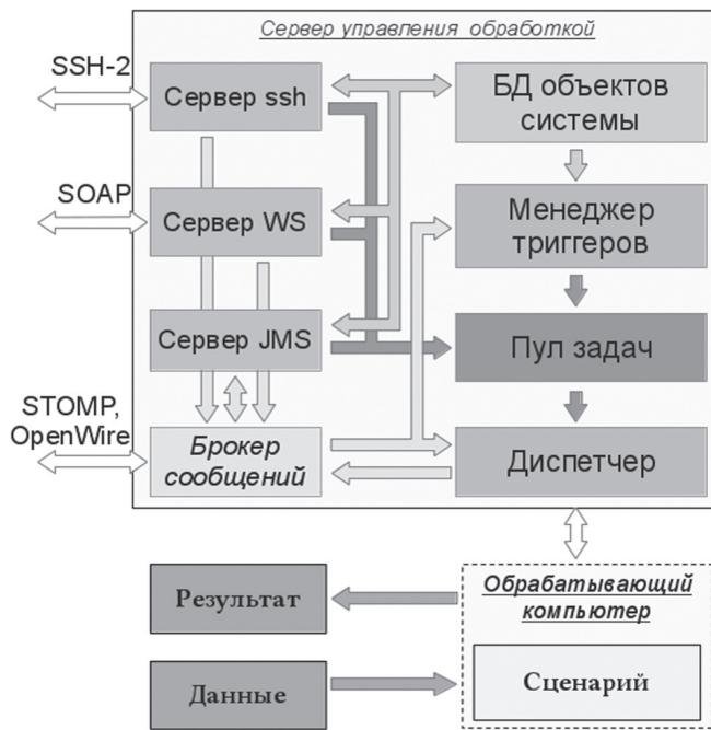
*Рис. 3. Общая структура работы распределенной вычислительной системы*
