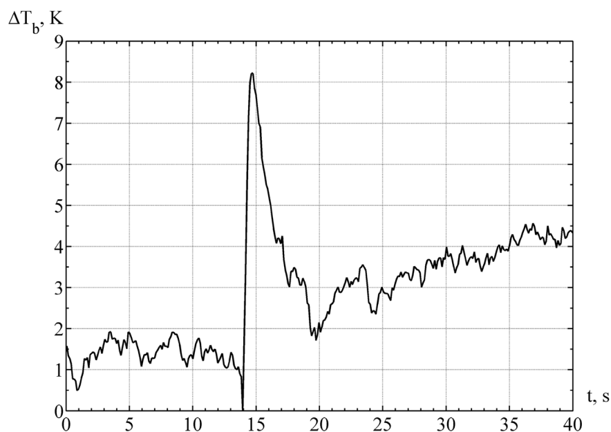
Рис. 3. Результаты измерений радиояростной температуры в трехсантиметровом диапазоне, соответствующих экспериментальным данным (рис. 2). Угол наблюдения 45^\circ на вертикальной поляризации
