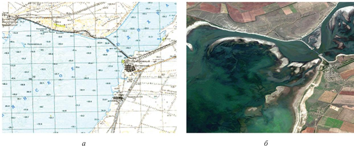
*Рис. 2. Чирской плес (верхний озерный участок Цимлянского водохранилища): а) по состоянию на 1978 г. (фрагмент топографической карты масштаба 1 : 100 000, береговая линия соответствует отметке уровня 36 м абс); б) по состоянию на момент съемки ИСЗ WorldView-2 24.09.2011 (уровень воды – 32,15 м абс)*
