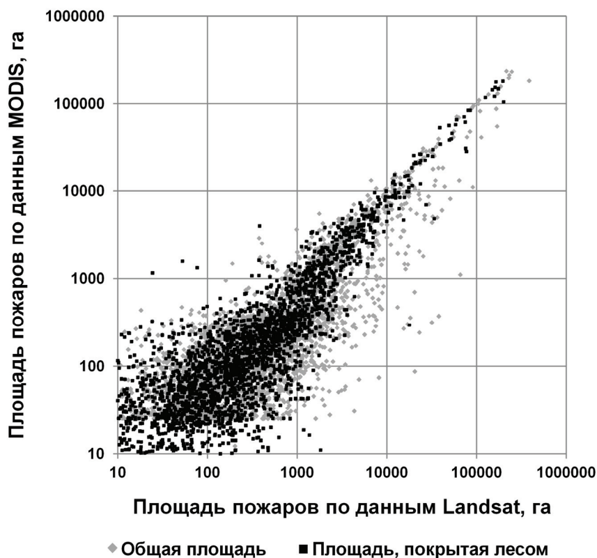
Рис. 2. Сопоставление оценок площади пожаров по результатам оперативного их детектирования по данным MODIS и картографирования поврежденных участков по данным Landsat
