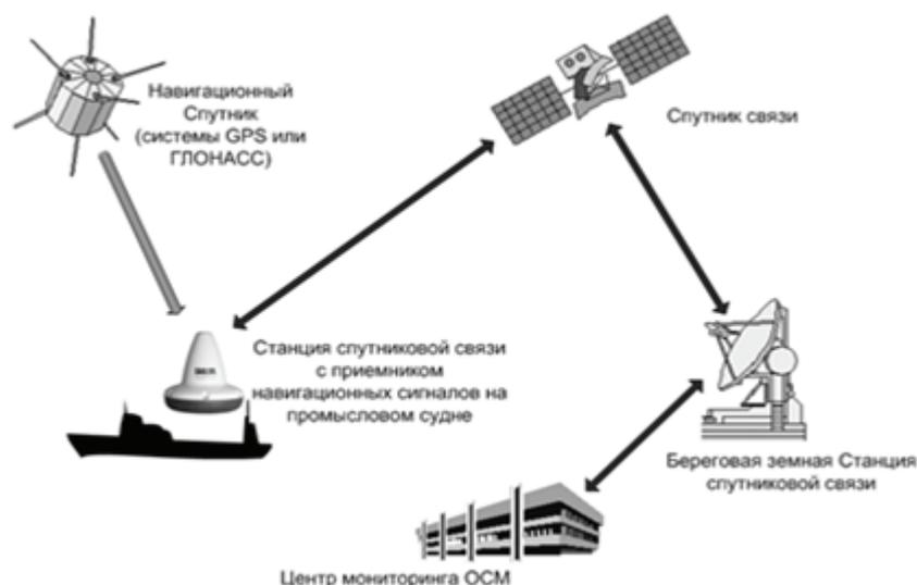
*Рис. 1. Схема определения позиций промыслового судна с помощью навигационных спутников систем GPS или ГЛОНАСС*
