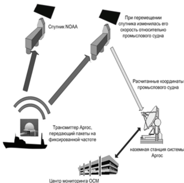
Рис. 2. Схема определения позиций промышленного судна с помощью системы Argos (позиционирование на основе эффекта Доплера)
