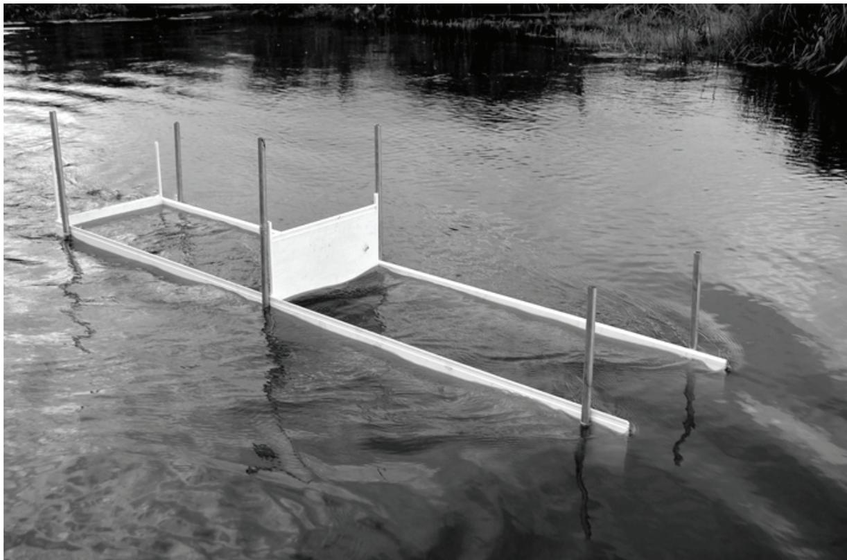
*Рис. 7. Фотография установки для исследования эффективности локализации нефтяных загрязнений боновыми заграждениями*
