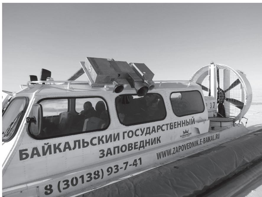
Рис. 1. Радиометрический комплекс (длины волн 8,8 мм, 2,3 см и 3 см), установленный на судно на воздушной подушке «Хивус»
