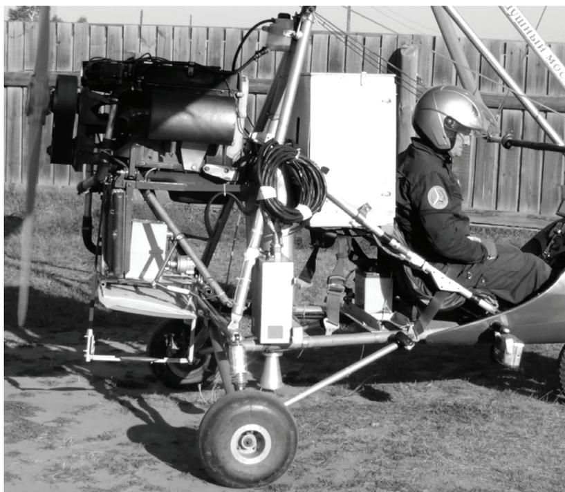
Рис. 2. Радиометры (длины волн: 8,8 мм и 2,3 см), установленные на дельталет «Фрегат»
