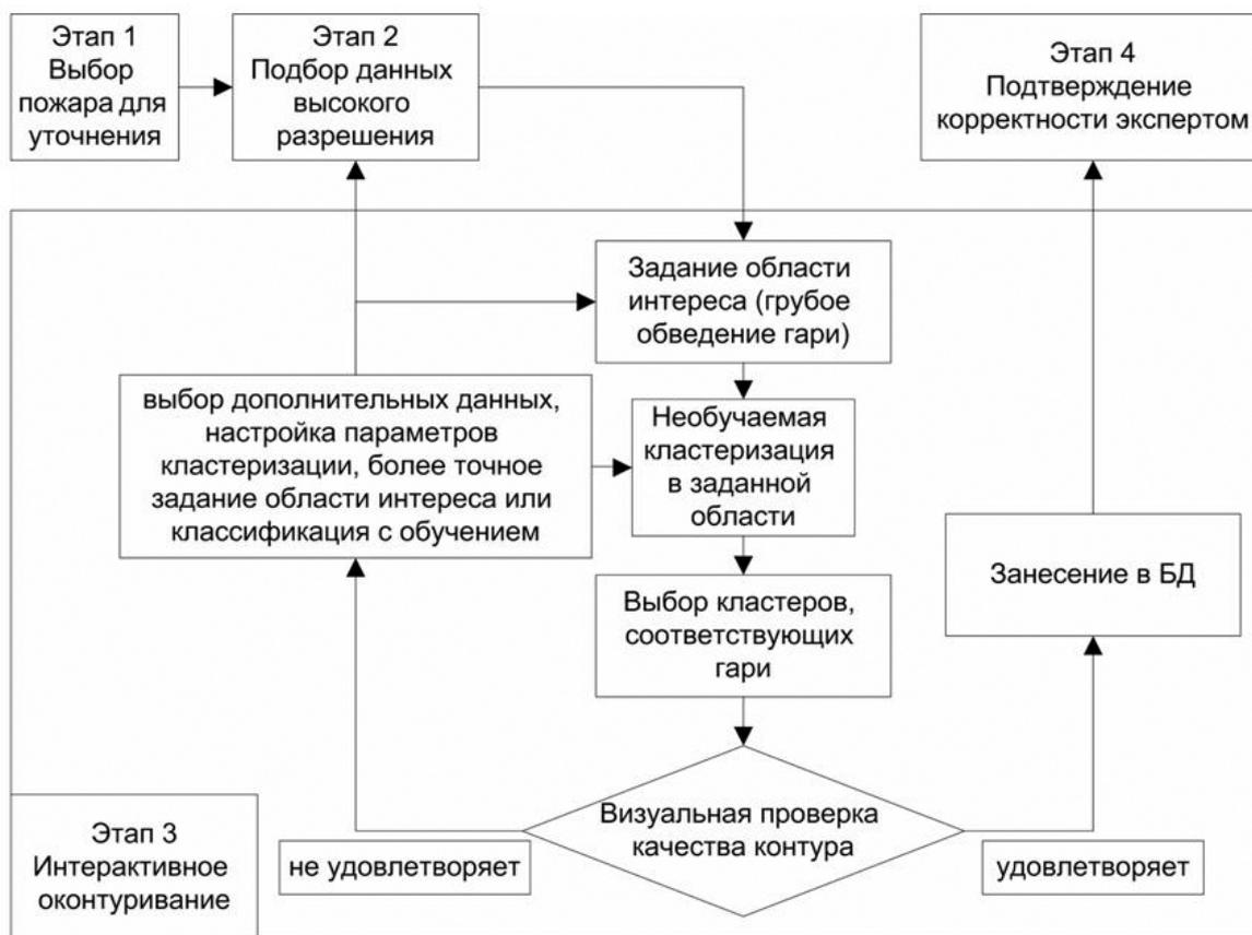
*Рис 1. Схема процедуры уточнения площади, пройденной природными пожарами, на основе использования данных высокого пространственного разрешения*
