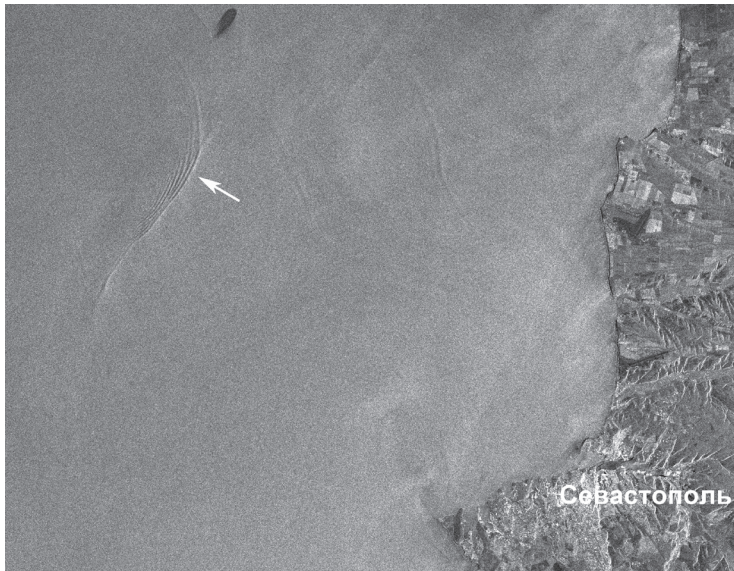
Рис. 7. Проявление цуга внутренних волн у западного побережья Крыма (отмечен стрелкой). Фрагмент ASAR Envisat изображения от 07.08.2009
