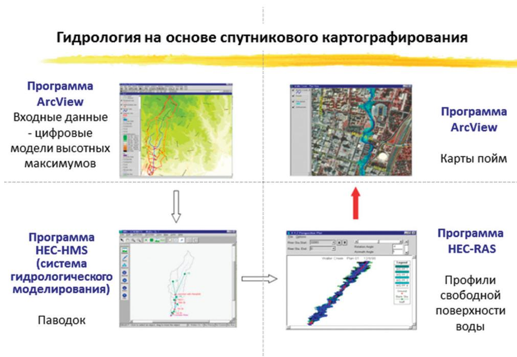
Рис. 4. Современные геоинформационные технологии обработки мониторинговых данных в интересах гидрологического прогнозирования
