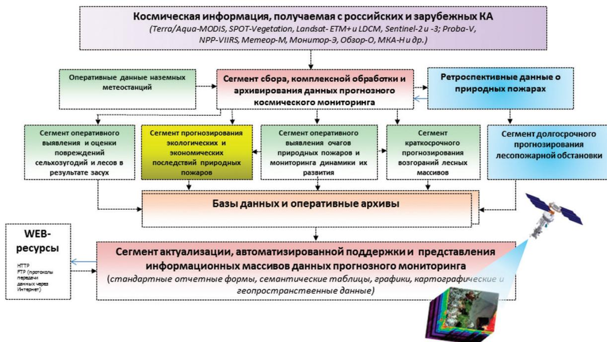
Рис. 2. Структура экспериментального участка прогнозного космического мониторинга лесопожарной обстановки (первый этап разработки «Наземно-космической системы прогнозного мониторинга лесопожарной обстановки»)
