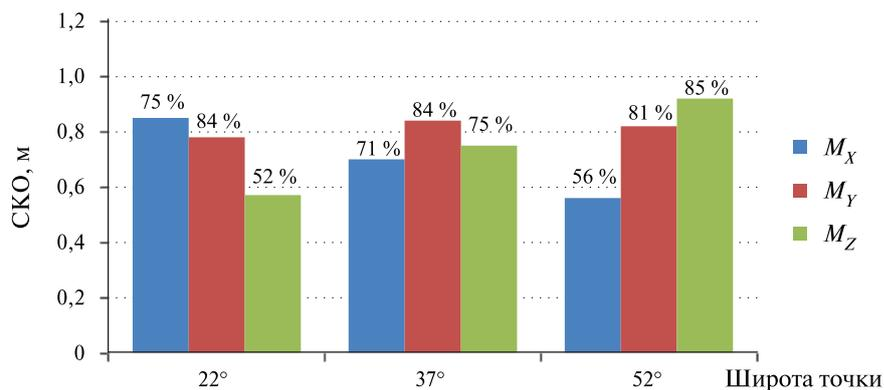
Рис. 3. СКО определения пространственных координат точки: наклонная орбита ( $J = 55^\circ$ ),  $H = 800$  км,  $f = 13\,300$  мм,  $m_U = 0,10''$
