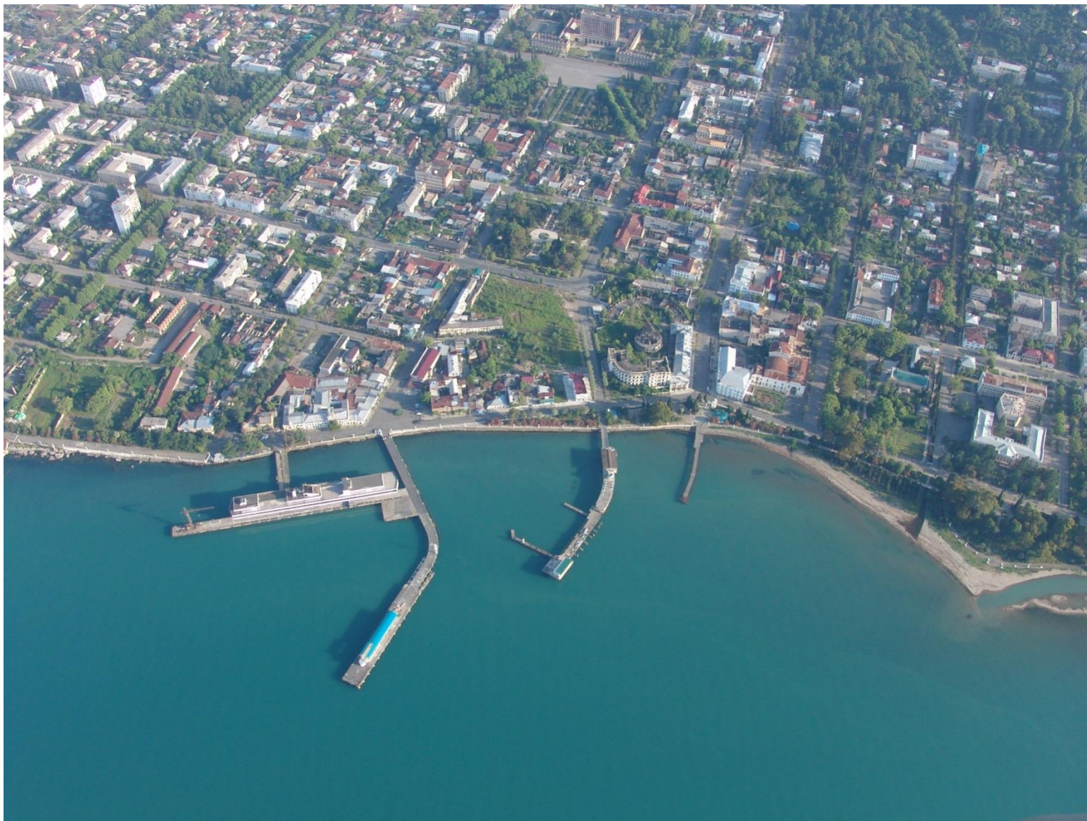
Рис. 23 Сухумская набережная, отсутствие пляжей в восточной части по причине сооружения мола для защиты порта укрытия
