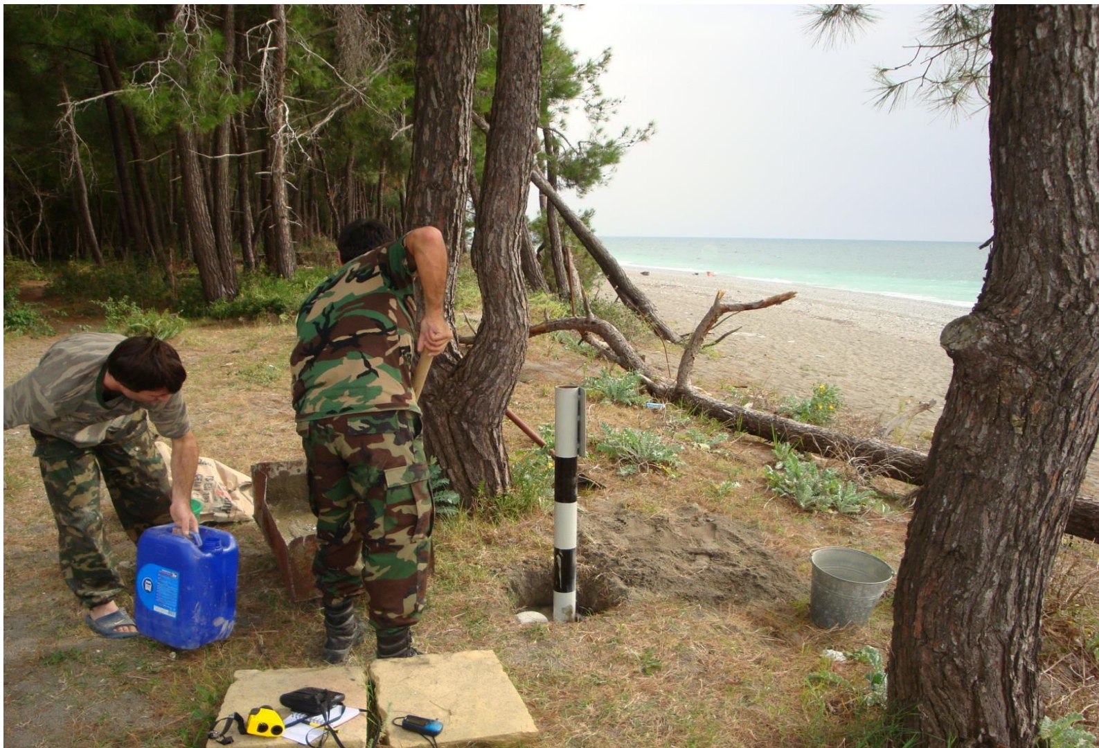
Рис 11. Пицундский мыс. Установка репера, для мониторинга динамики пляжной зоны
