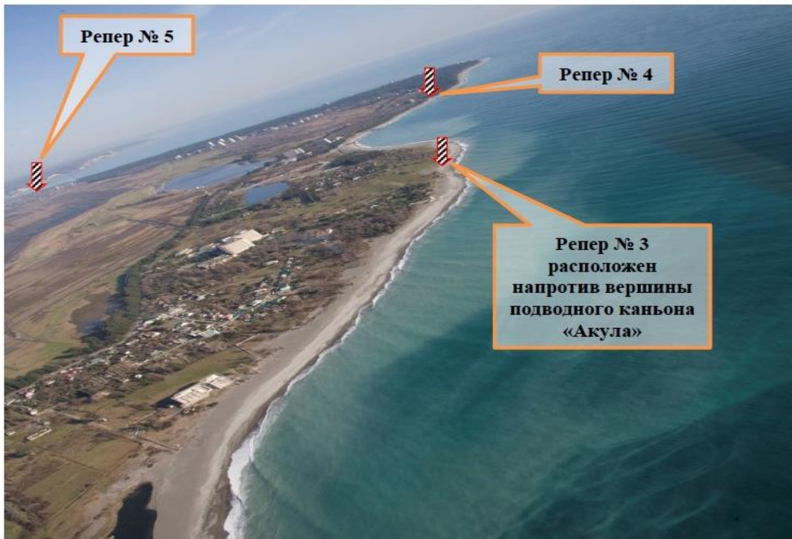
Рис 12. Пицундский мыс. Места расположения реперов стационарного наблюдения ширина пляжной зоны
