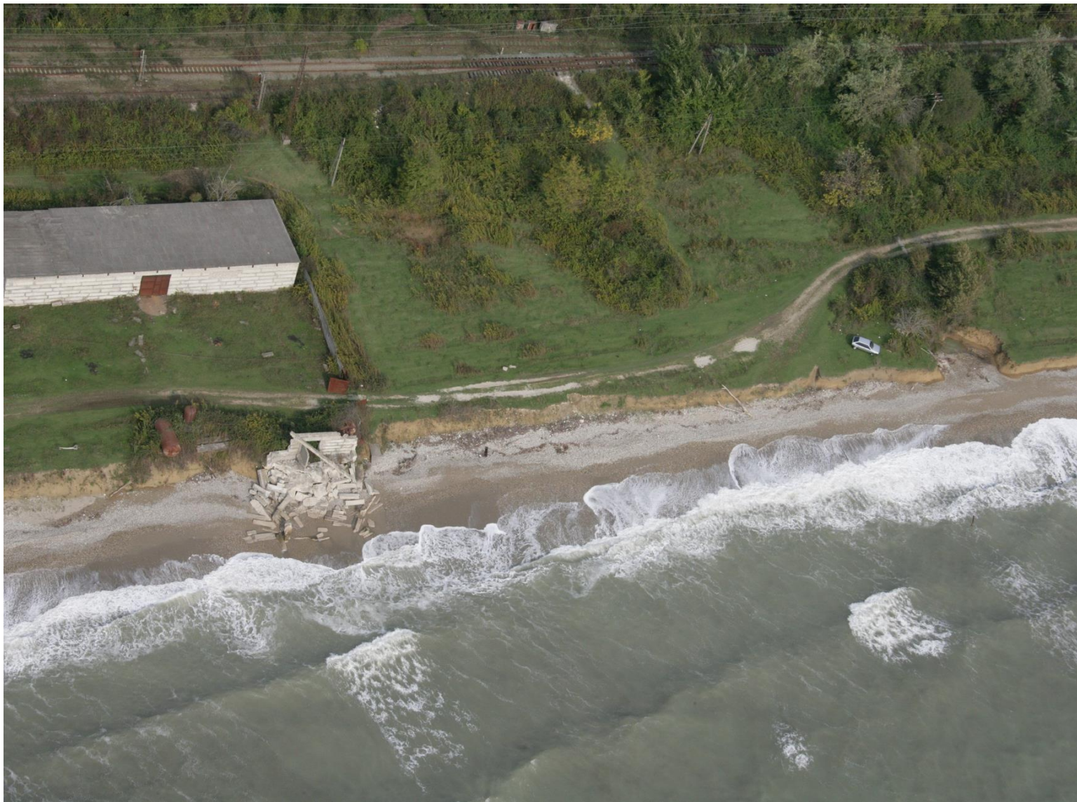
Рис 20. Абразия коренного берега, по причине слабого перемещения пляжеобразующего материала от р. Ааапста
