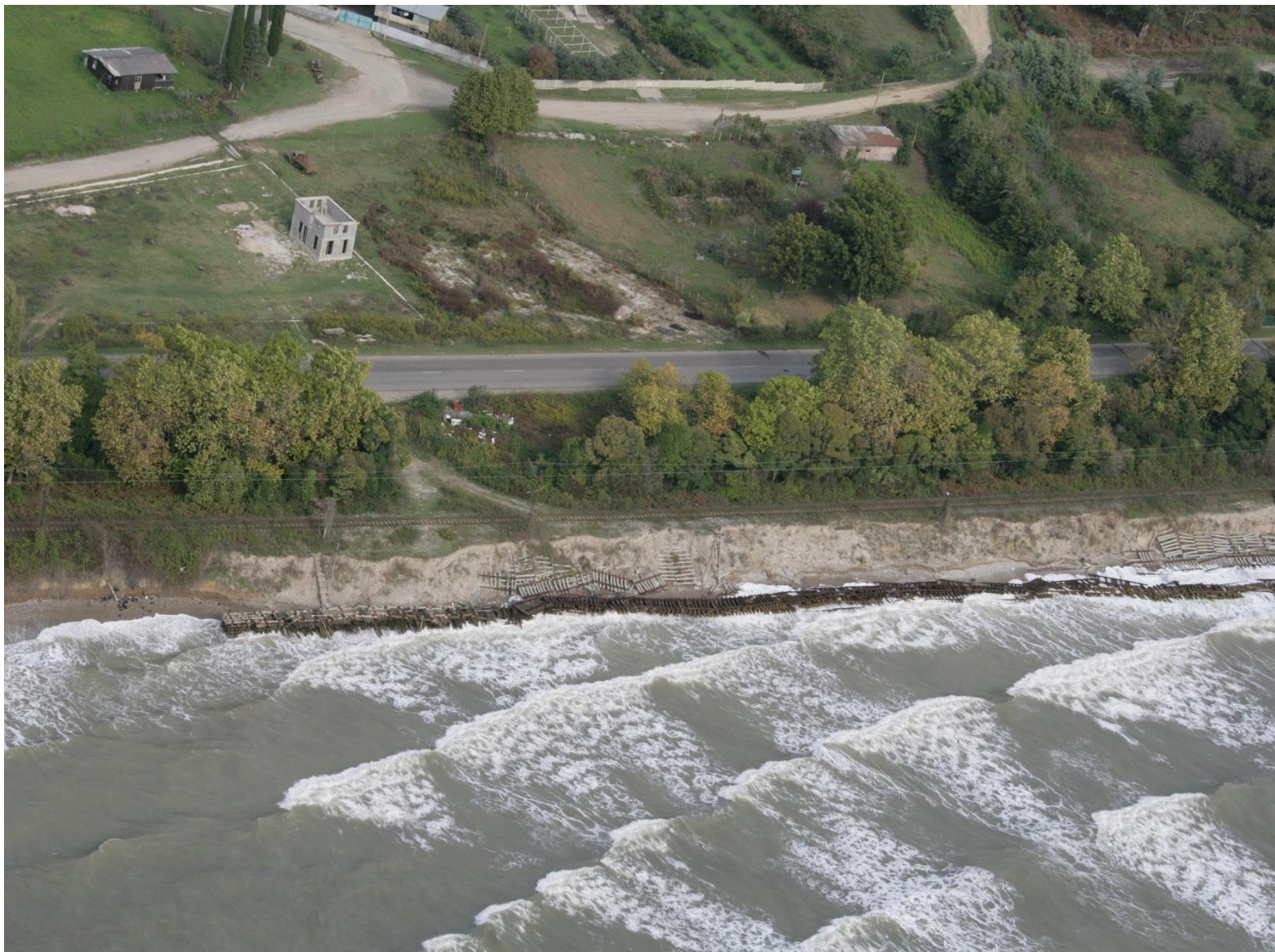
Рис 18. Абразия коренного берега, разрушающая железную дорогу
