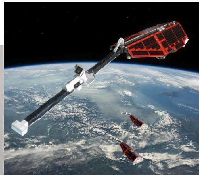
Вес каждого КА 468 кг; 106 кг топлива;
