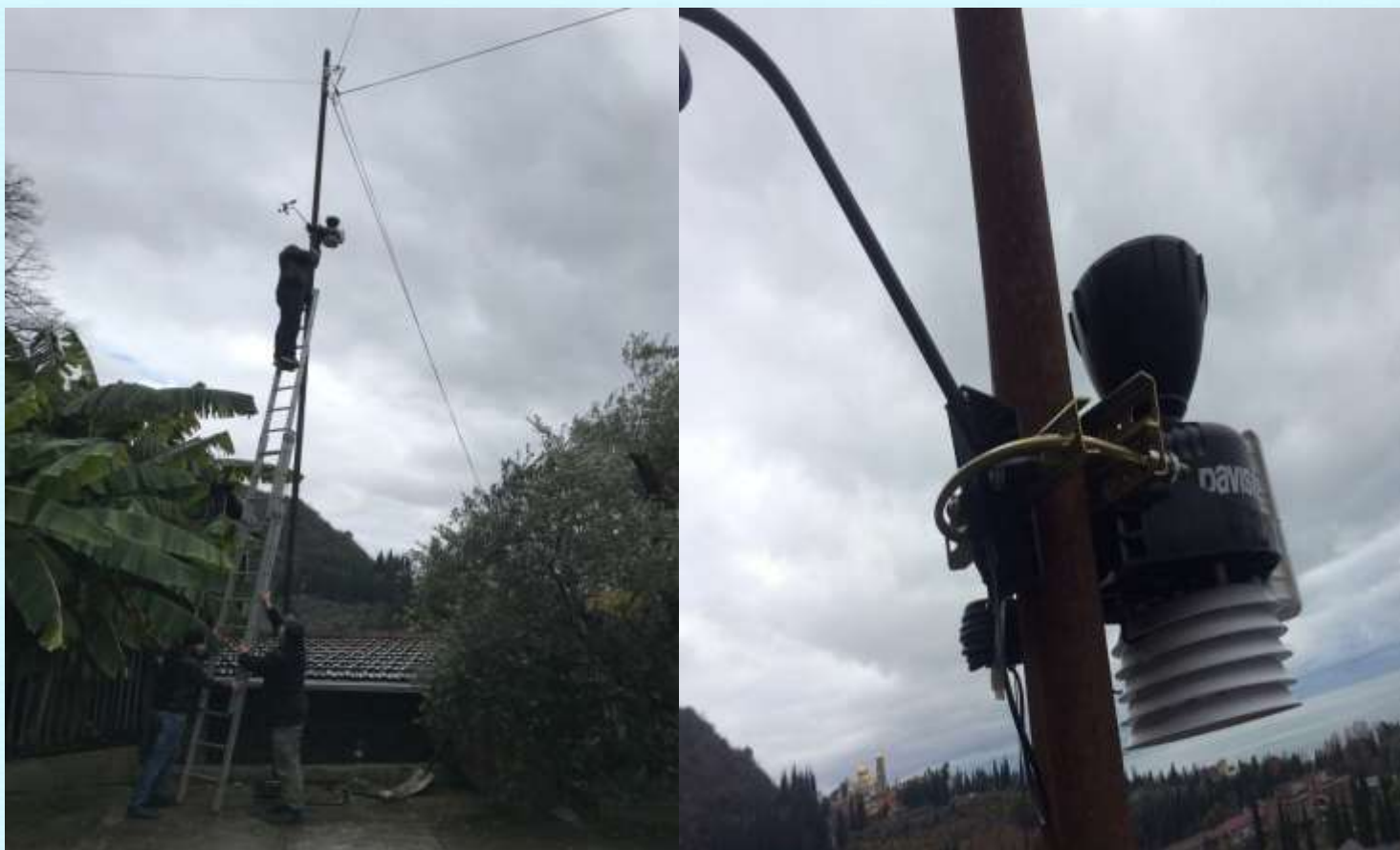
Установка автоматической метеорологической станции серии Vantage Pro2 на смотровой площадке Новоафонской пещеры (снимок сделан в декабре 2017 года).
