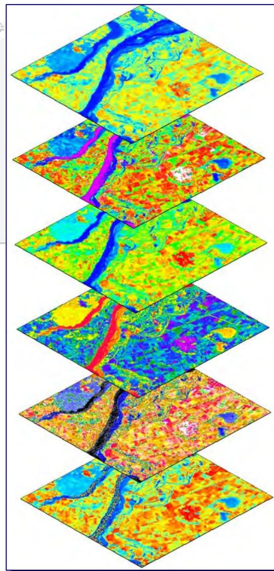
*Снимки радиометра ASTER спутника Terra в ИК диапазоне (8 – 14 мкм) по 6 каналам*
