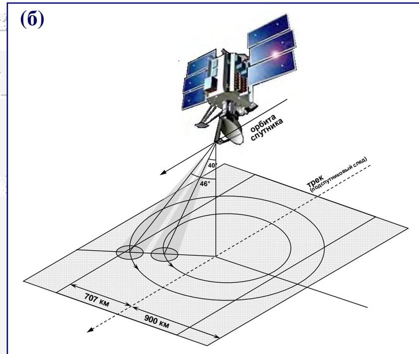
**Геометрия обзора: (а) – скктерометра SASS с фиксированным угловым положением антенн относительно направления движения спутника SEASAT и (б) – скктерометра SeaWinds спутников QuikSCAT и ADEOS-II, осуществляющего коническое сканирование двумя узкими лучами**
