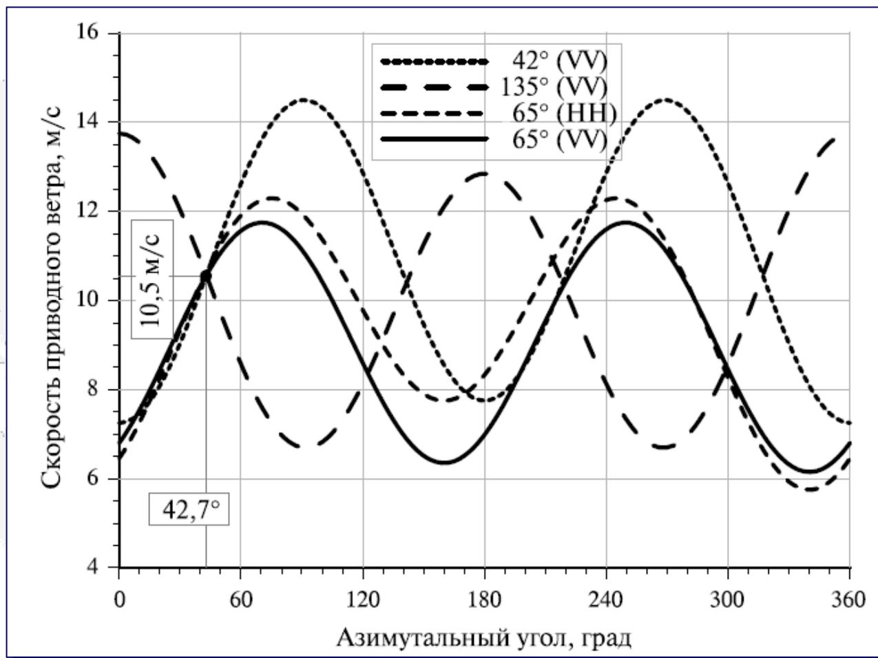
**Определение скорости приводного ветра на основе четырех измерений скаттерометра на трех антеннах, направленных под соответствующими углами к направлению движения спутника, и различных поляризациях. Точка пересечения всех кривых соответствует скорости ветра  $V = 10,5$  м/с и его направлению  $\phi = 42,7^\circ$**
