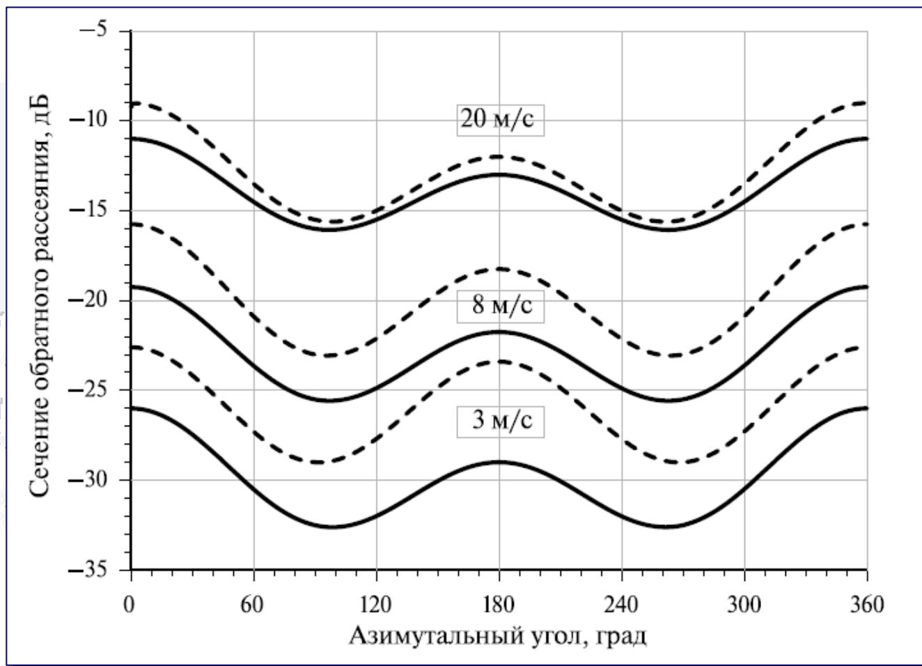
**Зависимость сечения обратного рассеивания от азимутального угла для скоростей приводного ветра 3, 8 и 15 м/с, направленного против движения спутника, для угла падения  $47^\circ$ . Сплошной линией показана зависимость для HH-поляризации зондирующего сигнала, штриховой линией — для VV-поляризации**
