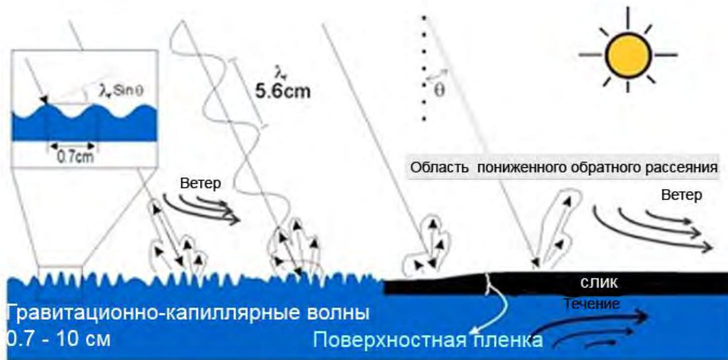
Наличие поверхностной пленки приводит к затуханию гравитационно-капиллярных компоненты поверхностного волнения, соответственно, на поверхности океана образуются выглаженные области (слики), которые проявляются на радиолокационном изображении как области пониженного рассеяния, которые могут служить индикаторами загрязнения поверхности
