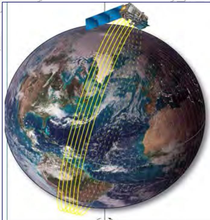
Половина орбиты, на которой спутник летит в северном направлении, называется восходящей (ascending) орбитой, а другая половина называется нисходящей (descending). Полярные орбиты существенно ниже чем геостационарные. Приборы размещаемые на полярноорбитальных носителях обеспечивают лучшее пространственное разрешение и позволяют получать высококачественные данные дистанционного зондирования..
